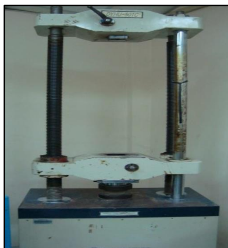
Rajah 9: Ujian kekuatan mampatan
