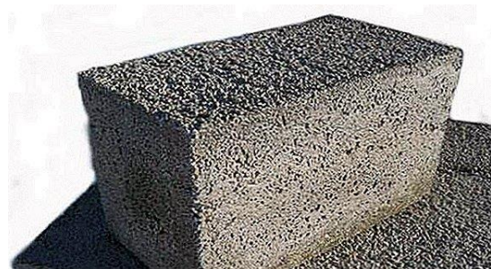
Rajah 10 : Ketumpatan perlite memberikan ketumpatan yang optimum untuk konkrit ringan
