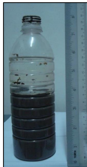
Rajah 7: Ujian jar bagi tanah laterit dan tanah liat
