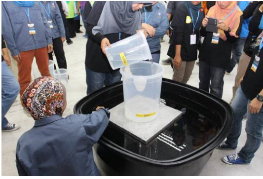
Rajah 12: Konkrit pontoon terapung selepas dikenakan beban 5kg
